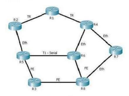
Esse diagrama de rede apresenta oito roteadores (R1 a R8) interligados por tecnologias de rede diferentes. As ligações entre os roteadores foram identificadas com uma sigla referente à tecnologia de rede utilizada. TR refere-se à tecnologia Token Ring = 16 Mbps, Eth refere-se a Ethernet = 10Mbps, FE refere-se a Fast Ethernet = 100Mbps, T1 refere-se a T1 (serial) = 1,544Mbps
